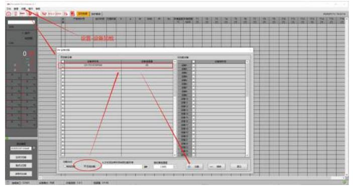
➤ **第二步:**点击“设置-设备加载”,弹出窗口,选择左下角的“无线加载”,在上方输入设备序列号、信道值,点击“加载”(多个设备加载可往下设备1、设备2...进行增加序列号及设备信道)
